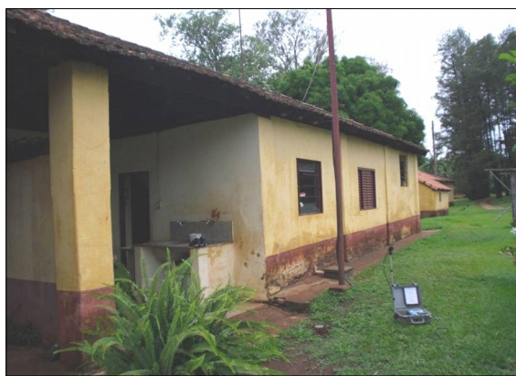
Foto 41: Aparelho para medir os efeitos das detonações instalado em residência próxima da pedreira
