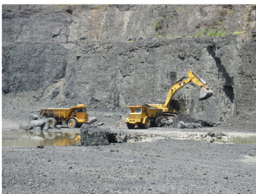
Detalhe do carregamento do material desmontado
