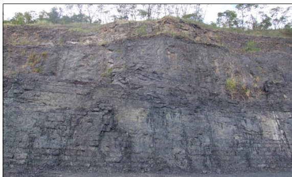
Foto 34: – Frente de lavra da Pedreira Santa Isabel, constituída por basalto, com denso fraturamento vertical. No topo observa-se horizonte de rocha alterada e solo de alteração e residual argiloso raso
